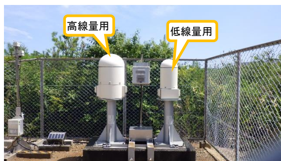
(写真5-2)モニタリングポストNo. 1の 空間線量率測定器
