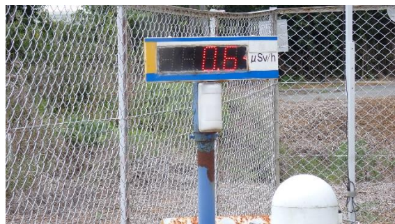
(写真4-2)モニタリングポストNo. 2の 線量表示器の指示値
