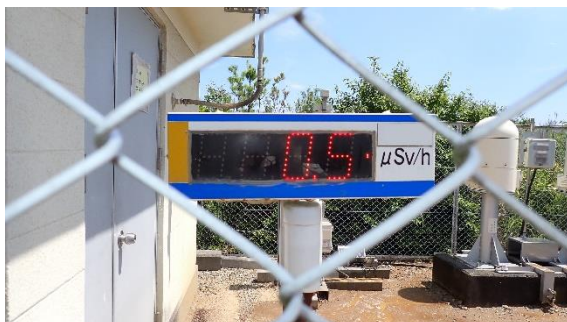
(写真4-1)モニタリングポストNo. 1の 線量表示器の指示値
