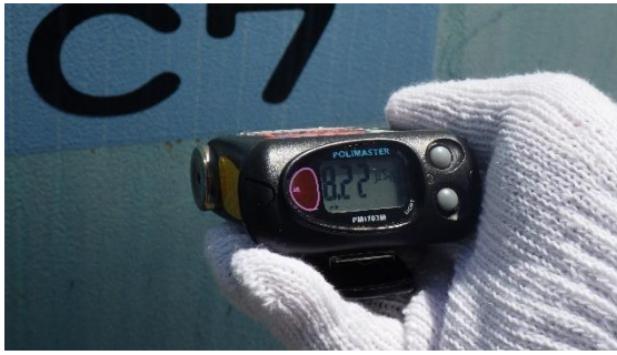
(写真7) 放射線量率の測定状況 ※指示値8. 22 \mu\text{Sv/h}
