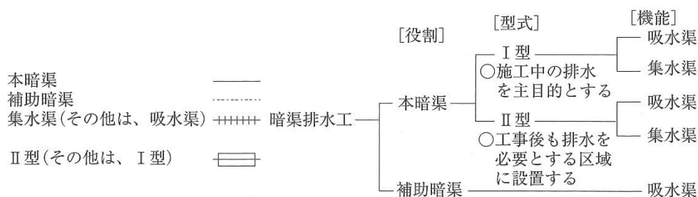
図 6(1)-10 地下水排除工の配置例
