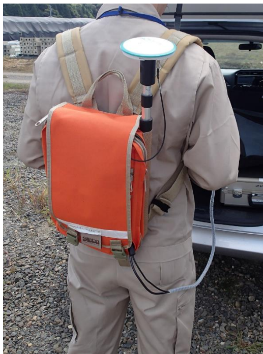
図 6-4 福島県環境創造センターで貸し出しを行っている歩行サーベイ機器
