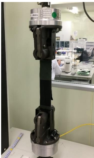
図 5-20 通気性防水シートの引張試験
