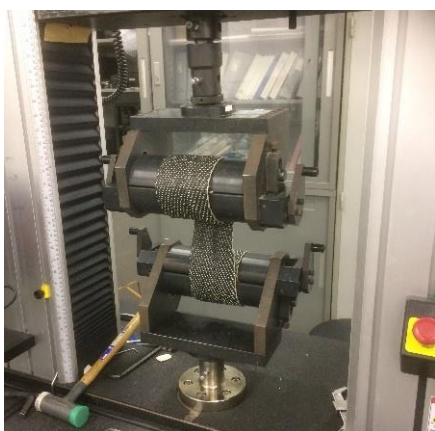
図5-18 吊ベルトの引張試験の様子
