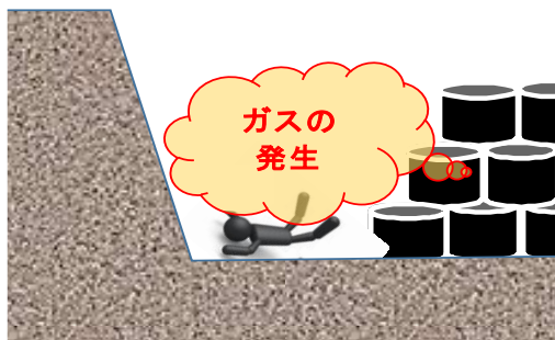
図 5-8 地下型・半地下型の場合の事故例(2)
