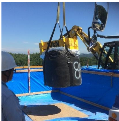
図5-16 除去土壌等保管容器の吊り上げ／吊りおろし試験の様子
