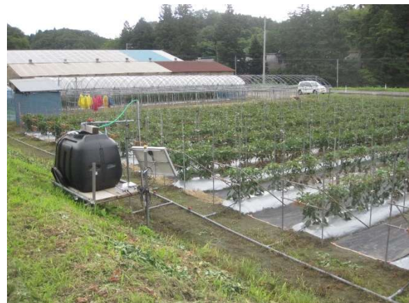
蓄電池式ソーラー自動灌水システム(ピーマン)
