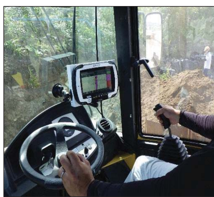
TS・GNSSによる締固め 回数管理
