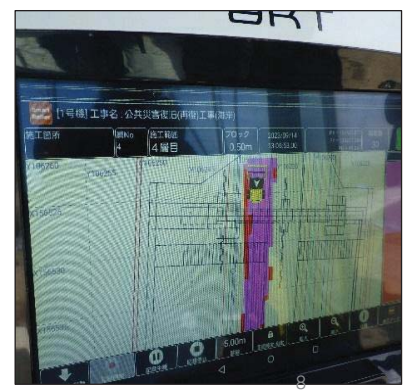
TS・GNSSによる締固め 回数管理
