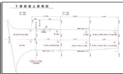
施工順序を明記した下層路盤工展開図
