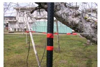
図2 温度センサーの設置方法
