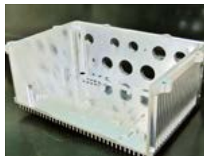
5面加工仕様の横型マシニングセンタを使用
