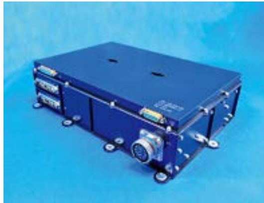
ホールスラスト用PPU (パワープロセッシングユニット)
