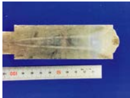
電子ビーム溶接で溶け込み深さ90mm入れた断面写真
