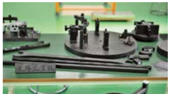
丸隆工業社内で成形・加工しているCFRP(炭素繊維強化プラスチック)の写真です
