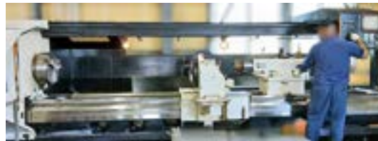
最大加工径φ500mm、芯間4000mm
