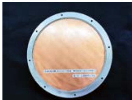
はやぶさ2に搭載された人工クレーターを生成するインパクトの電子ビーム溶接
