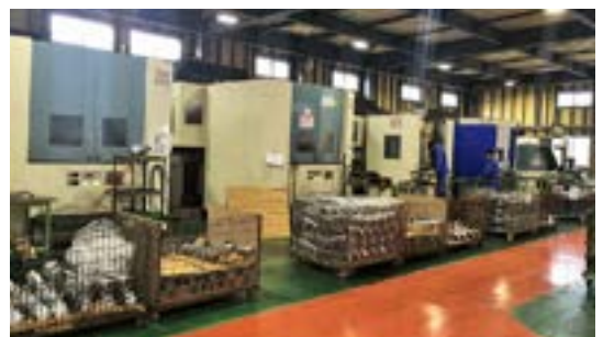
社内の横型マシニングセンターで最大のテーブルサイズ(630mm×630mm)の工作機械です
