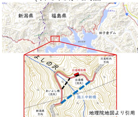
国道 252 号出逢橋仮橋進捗状況 (令和 8 年 5 月 7 日時点)
