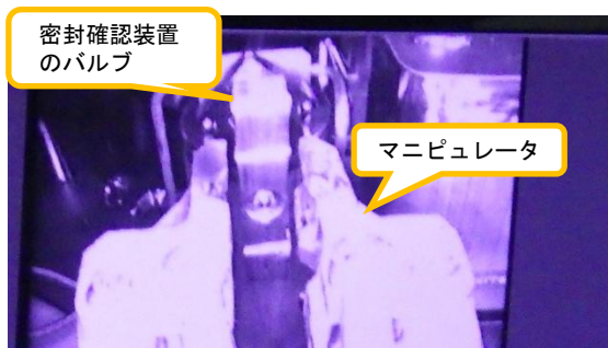
(写真7) マニピュレータによる密封確認装置のバルブ操作状況（遠隔操作室モニタを撮影）
