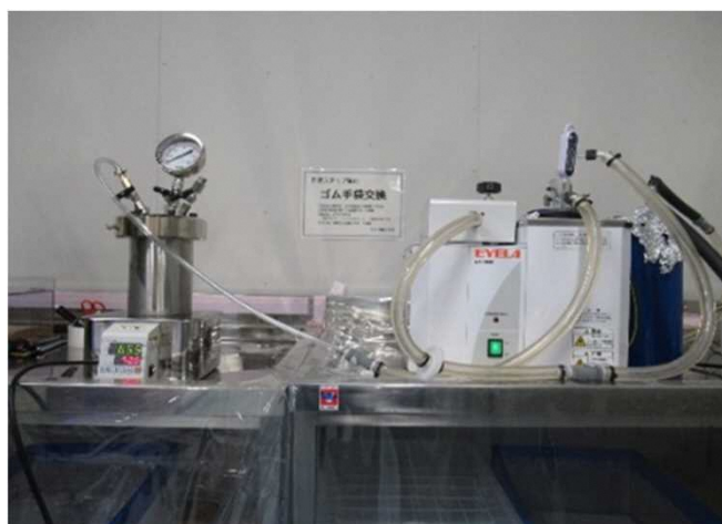
コールドトラップにより水を回収
