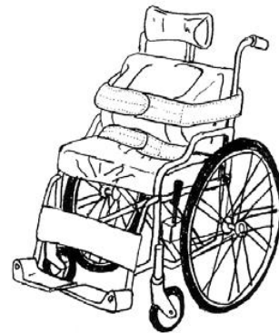
↑ モールド型(車椅子の構造フレーム)
