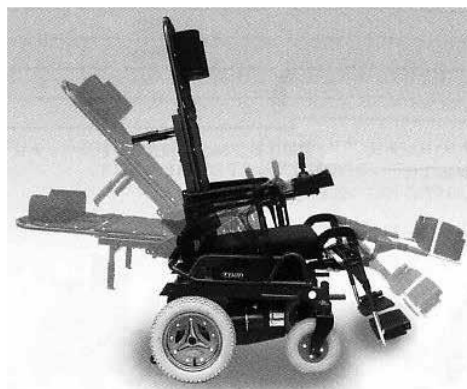
↑ 標準形 電動リクライニング機構
