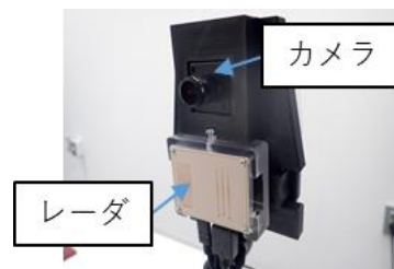
図3 カメラとレーダーの固定例 図4 アコースティックカメラへの適用
