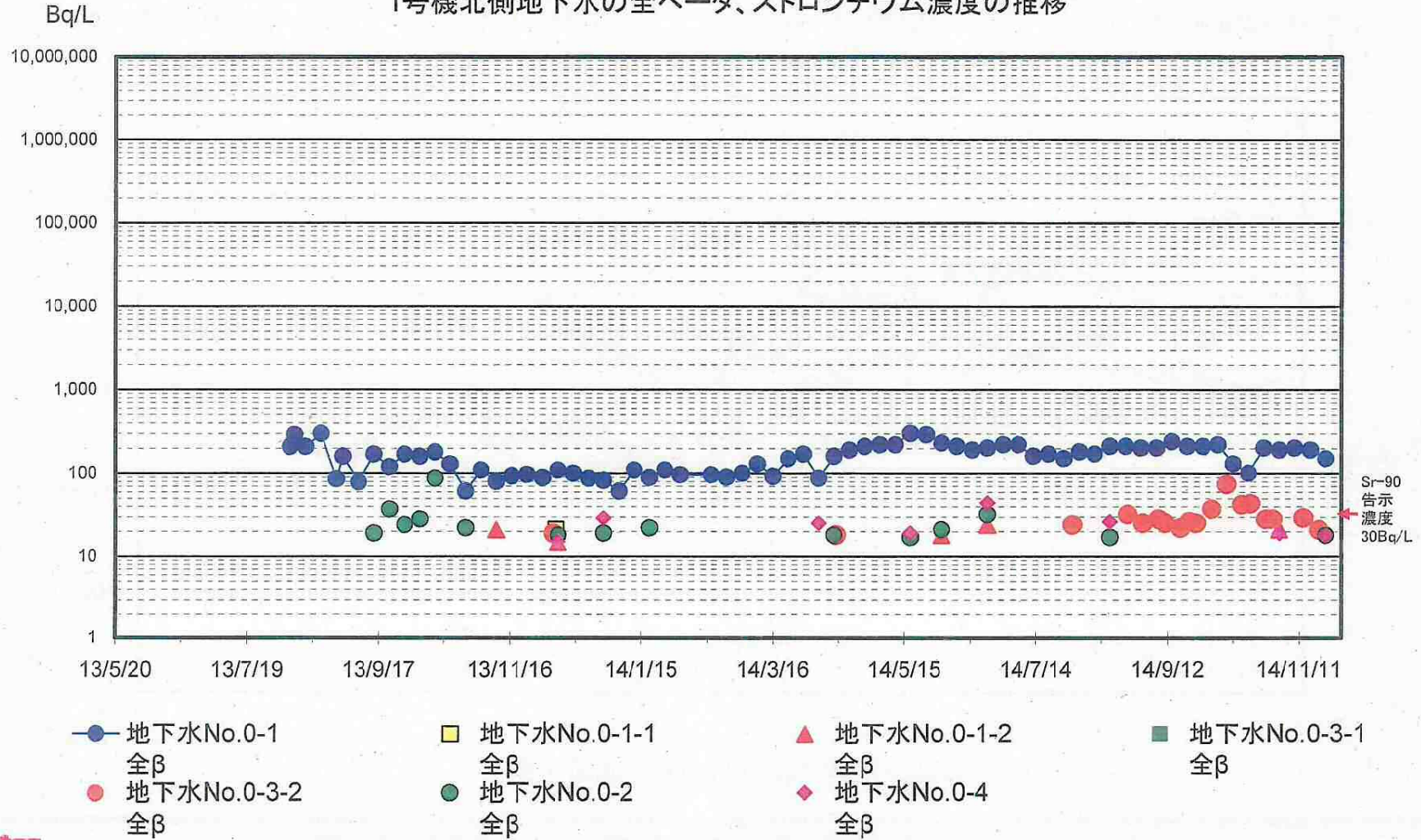
1号機北側地下水の全ベータ、ストロンチウム濃度の推移
