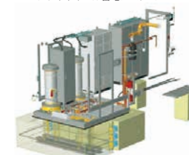
フライホイール蓄電システム
