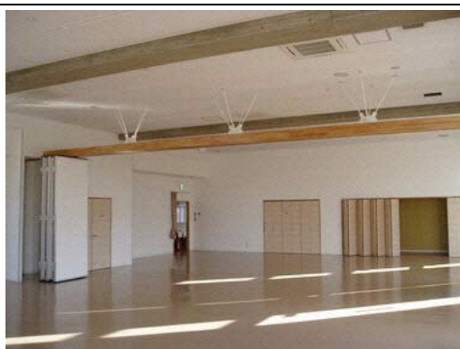
移動間仕切りのある会議室（太田市）
