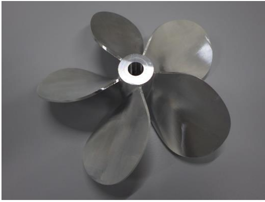
図5 プロセスAにより作製したスクリュープロペラ形状
