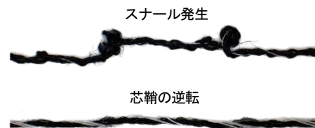
図2 合撚系(上)と芯鞘構造系(下)
