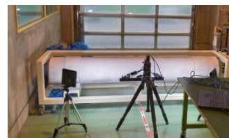
図7 蓄圧器模擬モデルのDIC測定試験状況
