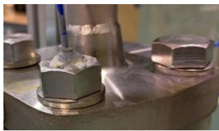
図3 ボルトへの熱電対の取付状況
