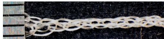
図10 緯糸用リリヤーン糸(加工後織度:560[D]) (PET+熱融着糸)
