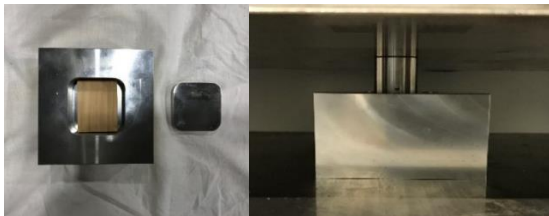
図2 平板形の試験片製作の成形型
