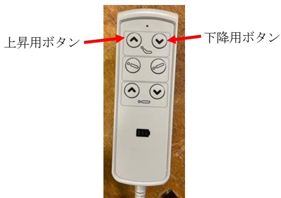
図9 TA16 アクチュエータ用コントローラ
