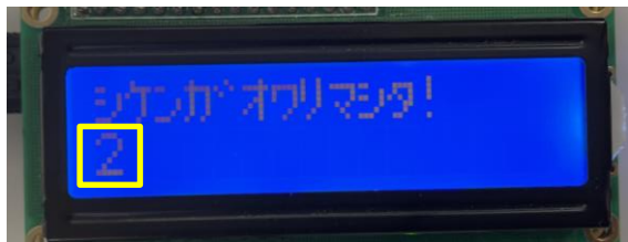
図5 LCDによる試験回数の表示 (上：試験中 下：試験終了時)
