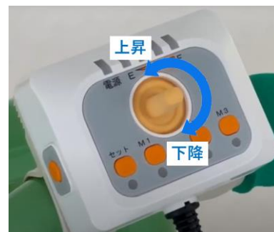
図3 「移乗です」の昇降動作用コントローラ（ミツバ社製）
