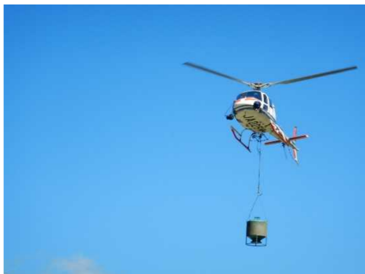
ヘリコプターによる資材運搬状況 (R4.9)
