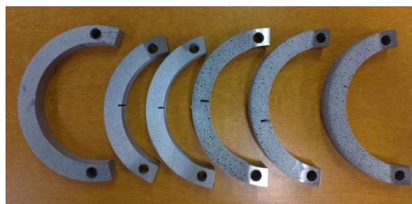
図3 模擬亀裂を加工した円弧試験片
