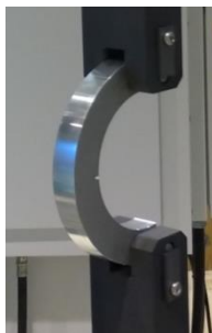
図 8 円弧試験片の取付け状態
