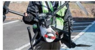
2 常葉プールより、高度120mまで、ドローンを上昇させ、安全を確認したうえで、自動操縦で都路診療所を目指す。アクシデントを想定し、バッテリー交換のため、都路グリーンパークを中継。
